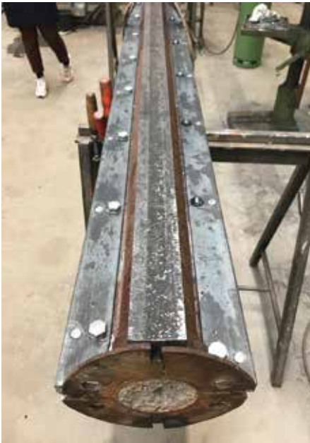
Onderzoek versterking van de bovenste kolommen.
